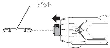
・ ビットピースを使用する場合は、スリーブを矢印方向に引きビットピース・ビットの順に差し込み、スリーブを放してください。
