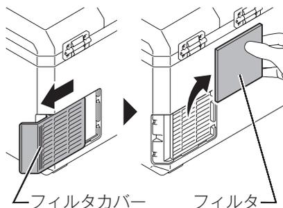
2. 掃除した後は、取りはずし方の逆の要領で、本製品にフィルタを取り付けてください。
