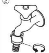
②パッドを引き抜き、下部を密着するまで締付けます。
