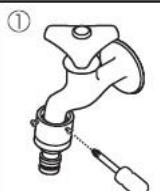
①3つのビスをゆるめパッキンを吐水口に押しつけビスで固定します。
