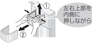
2 電球形LEDランプを交換する
