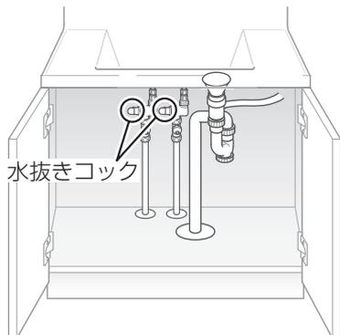
**1** 配管部の水抜き栓などにより通水を止めて、水抜きする
