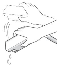
7 水が抜けたら、スパウトを元に戻し、レバーハンドルを下げ、水抜きコック・キャップを閉める
