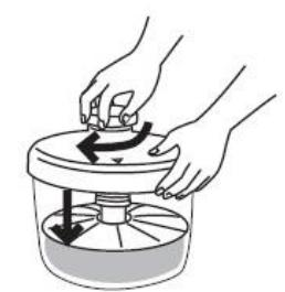
○フタを開けるときは必ずつまみを反時計方向にまわしてネジ棒を緩めてから開けてください。
