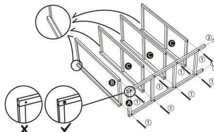
**2** 側面フレームをネジで連結します。
