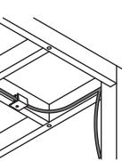
電源コードを固定せずに使用すると、断線やショートを引き起こし、火災や感電、故障の原因になります。
