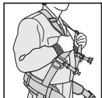
②胴ベルトを腰骨の高さに合わせ、体にフィットするように長さを調節し装着する。
