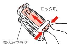
①本体裏側のロック爪を図のように閉じながら、差込みプラグを上方に押し出すす。
