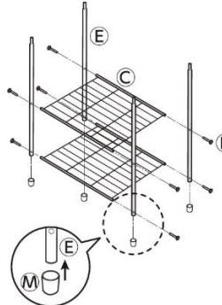
2 ⑦長いパイプ上を⑧長いパイプ下に差し込み、ドライバーで⑨ボルトで止めます。
