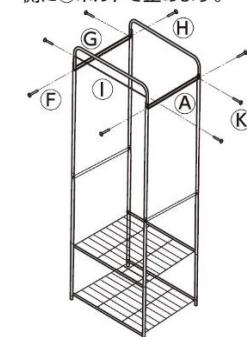
4 ドライバーを使用し、⑮短いパイプ上に、⑯ハンガーパイプを⑯ボルトで止めます。仮締めしていたネジをすべて本締めします。
