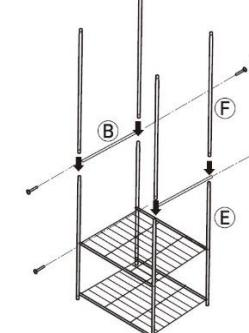
3 ⑩長いパイプ上に⑪曲げパイプを差し込み、ドライバーで⑫長いパイプ上に⑬短いパイプ上を⑭ボルトで止めます。
