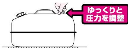
**警告** 内部の圧力を調整せずに給油キャップを開けると中身がふき出る恐れがあり非常に危険です。必ず圧力を調整してください。
