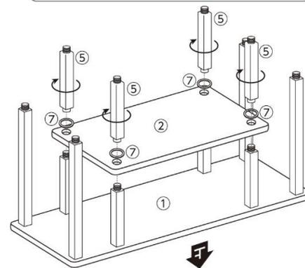
3 ③底板を図のように乗せ、⑥脚を矢印の方向に回して取り付けます。
