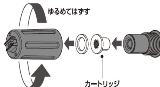
④ カートリッジ内部のフィルターに、液体洗剤やゴミ等の付着で、交換する必要がある場合は、上記のフィルター交換方法をご参照ください。
