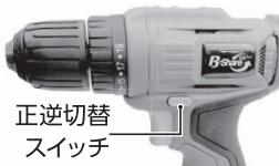
正逆切替スイッチは本機が完全に停止してから操作してください。※故障の原因となります。
