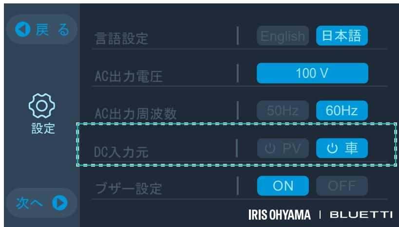
車のカーソケットと本体の車(カーソケット)入力ポートを、付属のカーチャージケーブルと入力変換アダプターで接続する
