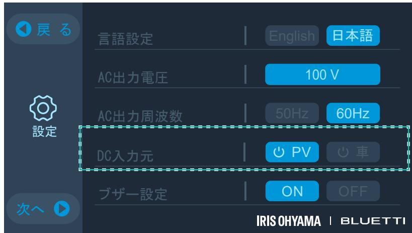
ソーラーパネルと本体の PV(ソーラーパネル)入力ポートを、付属の MC4 ソーラー充電ケーブルと入力変換アダプターで接続する
