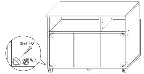
※横揺防止部品は、背板と 他の部材(天板・地板・側板など) の間に取り付けてください。
