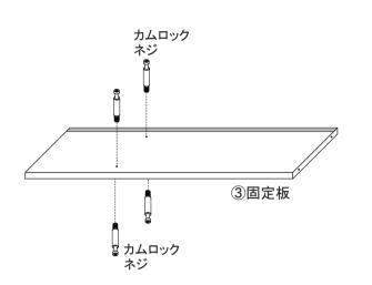
【工程 1】 固定板に、仕切板(大・小)を取り付け、 カムロック受けで固定します。
