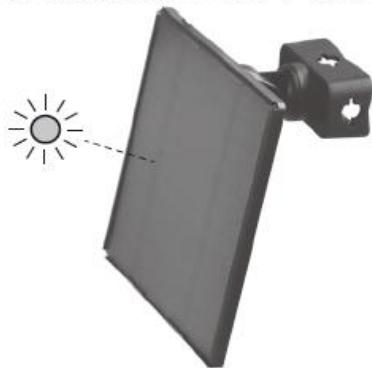
**3 固定クランプ台を適切な向きにして、蝶ナットをしっかりと締める**
