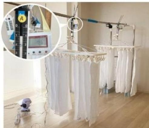
角ハンガーにタオルを8枚干したものを設置し、重量と温度、湿度を測定。
