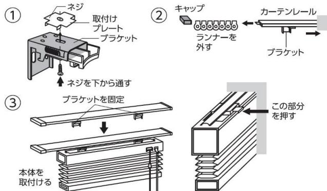
① ブラケットの下からネジを通して、プレートをゆるめに取付けます。
