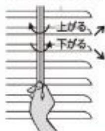
回転操作棒を回して、調整します。
