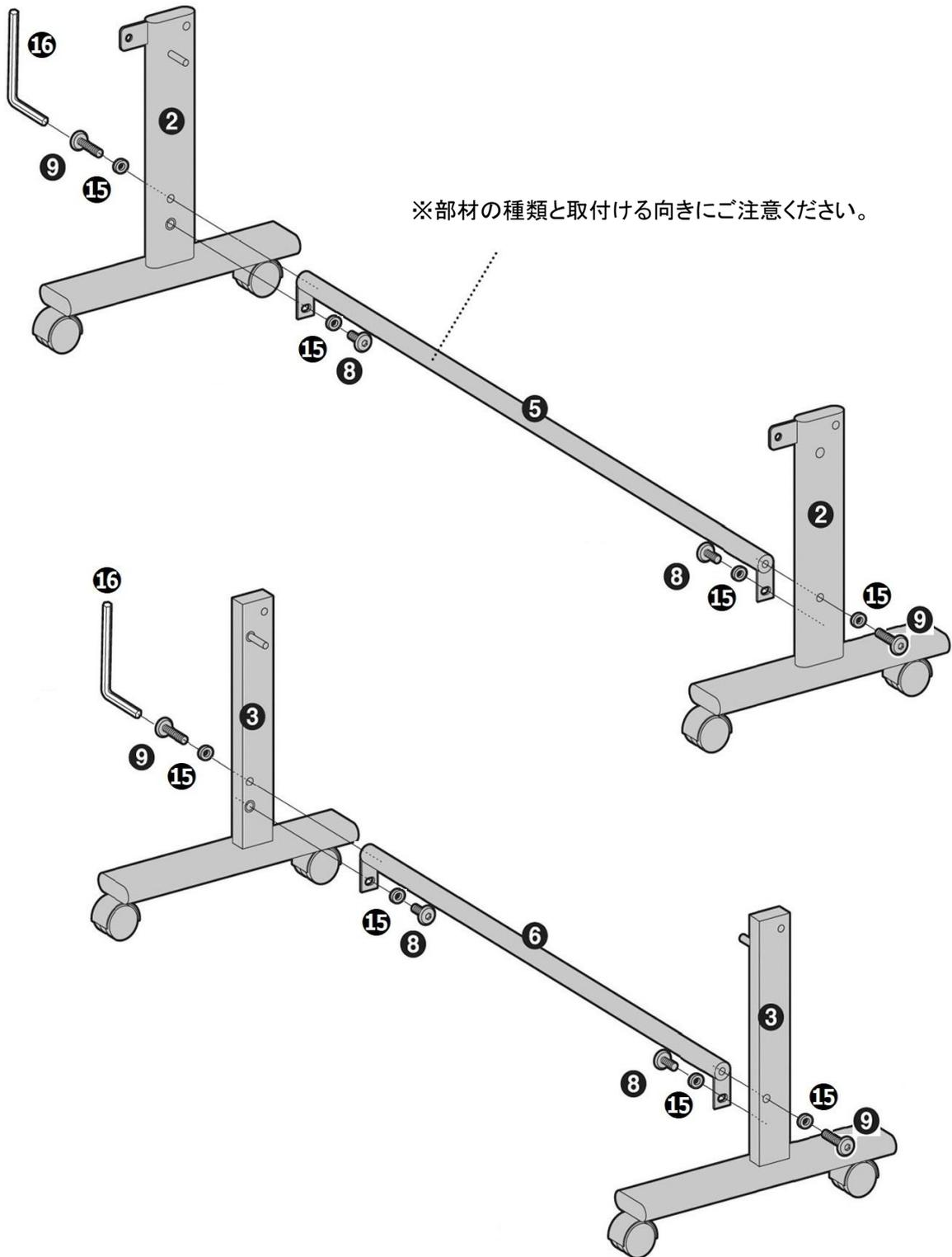
同様に③ベッド脚(細)x2と⑥ベッド脚フレーム(短)を⑧ボルトBx2と⑨ボルトCx2と⑮ワッシャーx4で、⑯六角レンチを使用して取り付けてください。
