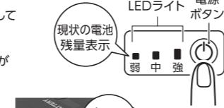
② 約30秒間、電池パック残量表示LEDが点灯しますので、電池の残量を確認してください。
