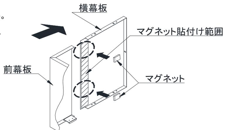
※マグネット取付位置は前幕板と横幕板の隙間を見て調整してください。
