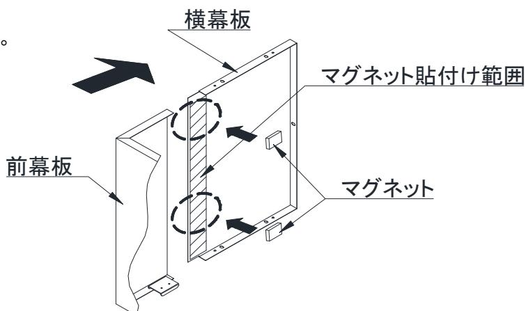
※マグネット取付位置は前幕板と横幕板の隙間を見て調整してください。
