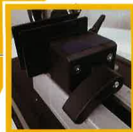
即座に材料を固定するクイック クバイス付き
