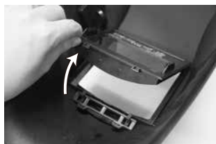
液晶カートリッジフレームを枠から外す
