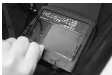
図5. 内側カバースプレートの交換方法
