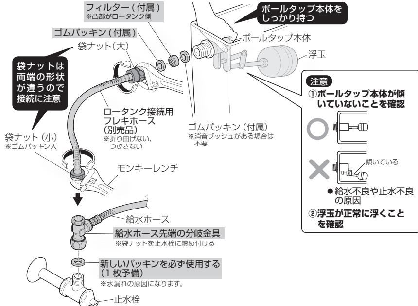
取りはずした給水管を切断して使用する場合
