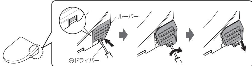
3 脱臭カートリッジを取りはずし、新しい脱臭カートリッジを取り付ける
