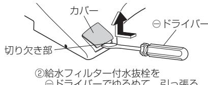
②給水フィルター付水抜栓をθドライバーでゆるめて、引っ張る
