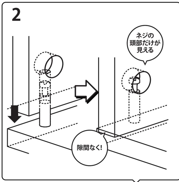
カムロックネジに、接続するパーツをかぶせ、カムロックネジの頭部のみが穴から見える状態になっていることを確認してください。
