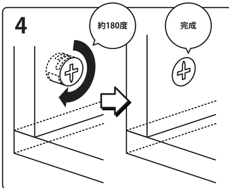
ドライバーでカムロックを時計回りにゆっくり約180度程度回して、取り付けの完成です。
