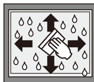
シートがずれないように押さえながらヘラで中央から外側に向かってムラのないように水と空気を押し出しながら圧着します。
